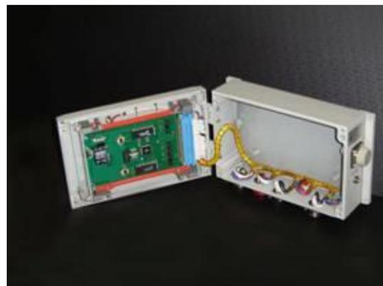
**Назначение:** обеспечение обмена измерительной информацией с блоком детектирования
