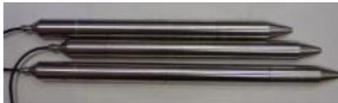
Оборудование для гамма-нейтронного каротажа
