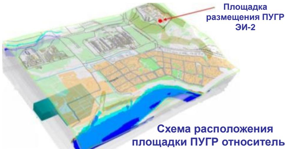
Схема расположения площадки ПУГР относительно зоны разгрузки грунтовых вод
