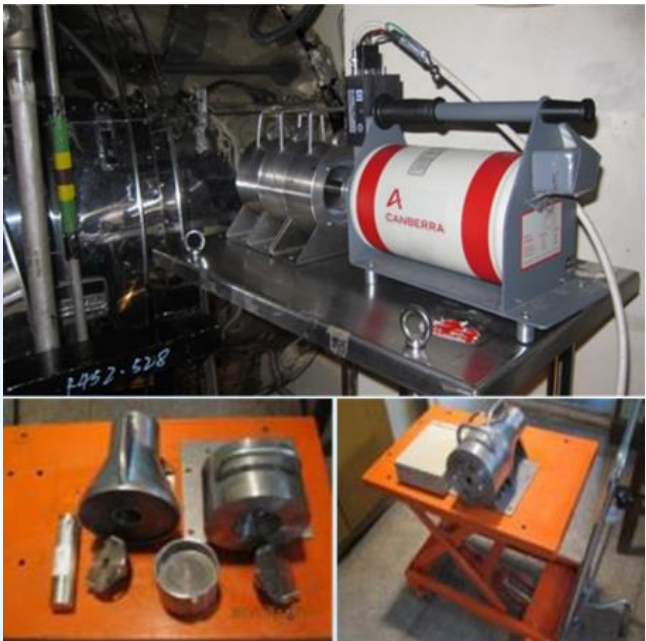
Система измерения параметров источника гамма-излучения с помощью детектора с ОЧГ
