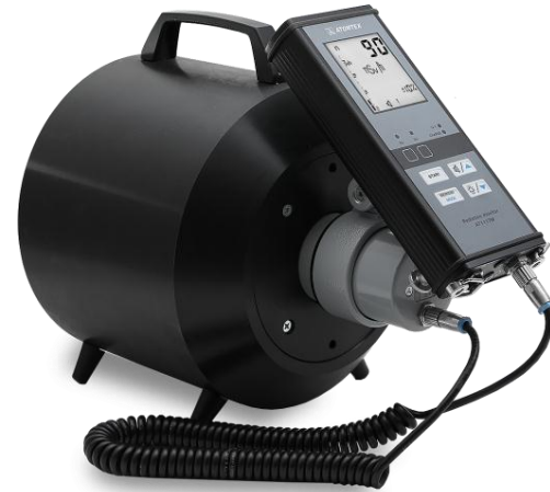
Пример гелиевого счётчика с модератором нейтронов
