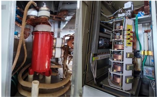
генераторная лампа ГУ-98АМ в штатном месте установки генератора и штатные средства регулировки накала лампы в генераторе
