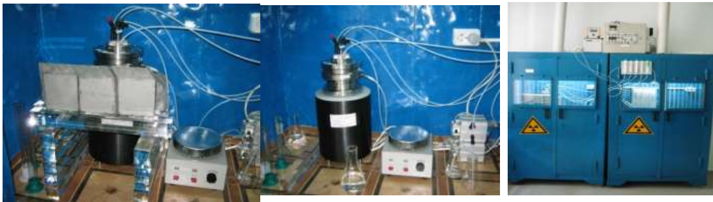
Рис. 1. Установка центробежной экстракции ^{99m}\text{Tc} из молибденовой мишени. Изготовлено в Федеральном центре по проектированию и развитию объектов ядерной медицины» ФМБА России
