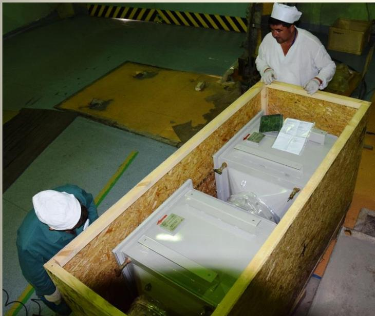
Кожухи для установки модулей фильтров
