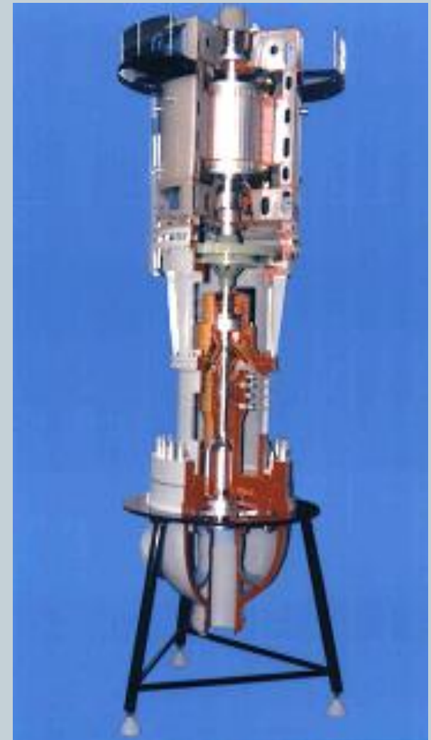
Главный циркуляционный насос ЦВН-8.
