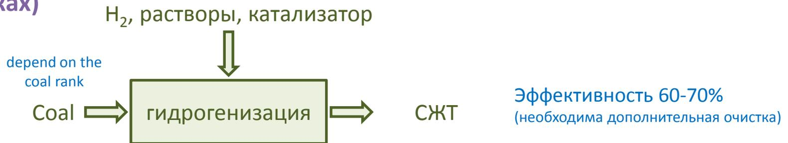
Большинство ТЕХНОЛОГИЧЕСКИХ процессов проходят при высокой температуре (350-450 °C) и высоком давлении (20-30 МПа)
