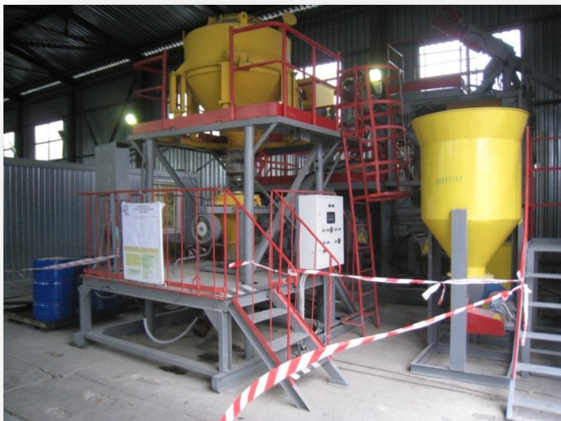
Рабочая камера для сортировки и фрагментации РАО
